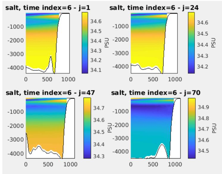
Figura 3: Secciones verticales de salinidad para el dominio Chile Central
